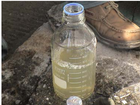
写真-5 腐敗槽の上澄水(事務所)
