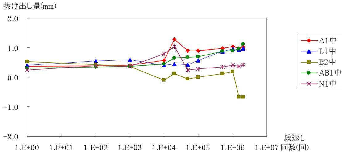
図 3.3.4(b) 鉄筋の抜け出し量(Dc)
