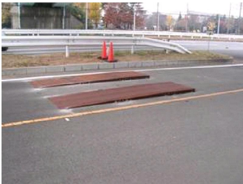
(a) 路上に設置されたサスペンション振動試験用ステップ
