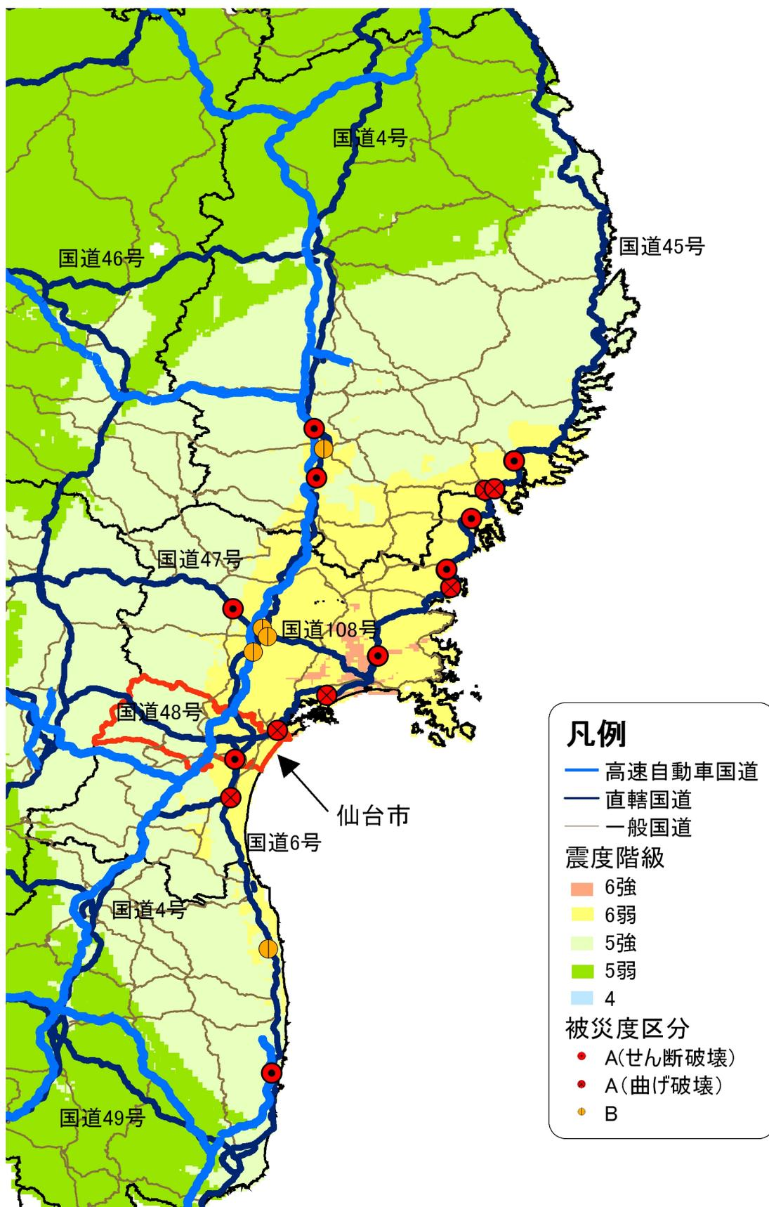
図 4-6 本線橋の被災度判定結果
