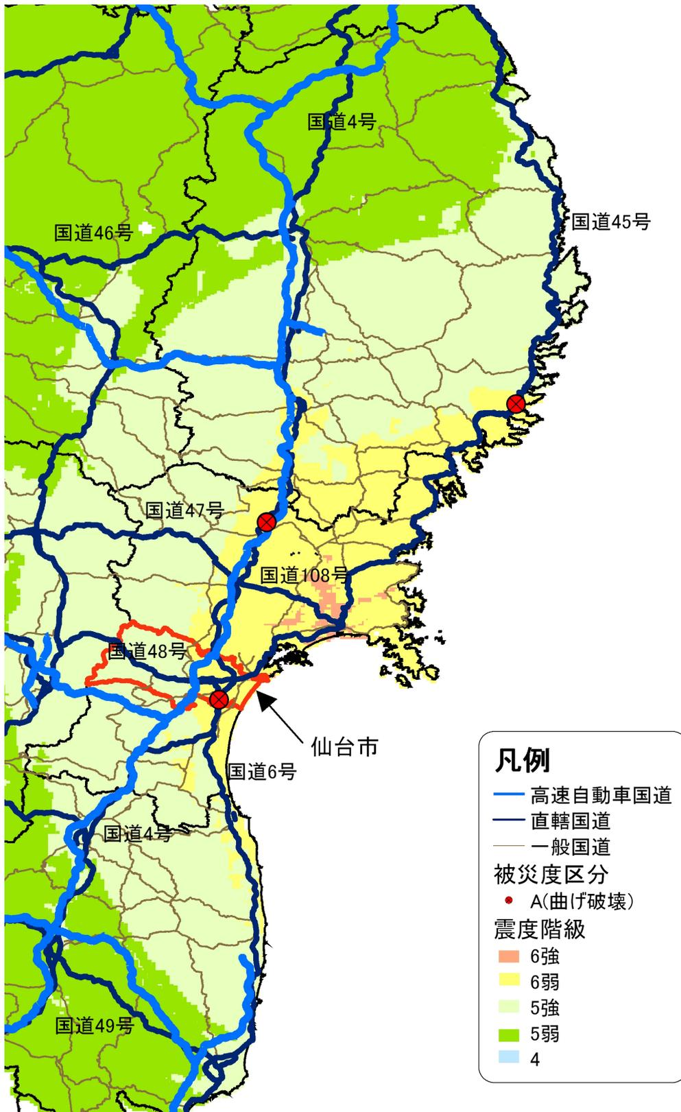
図4-7 側道橋の被災度判定結果
