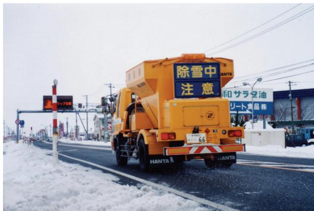
写真2-1 凍結抑制剤散布車による作業状況
