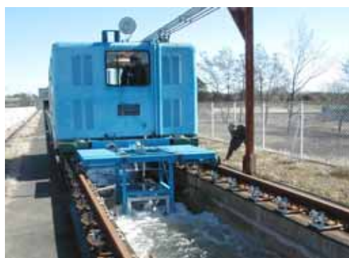
写真－2 水車の走行試験
