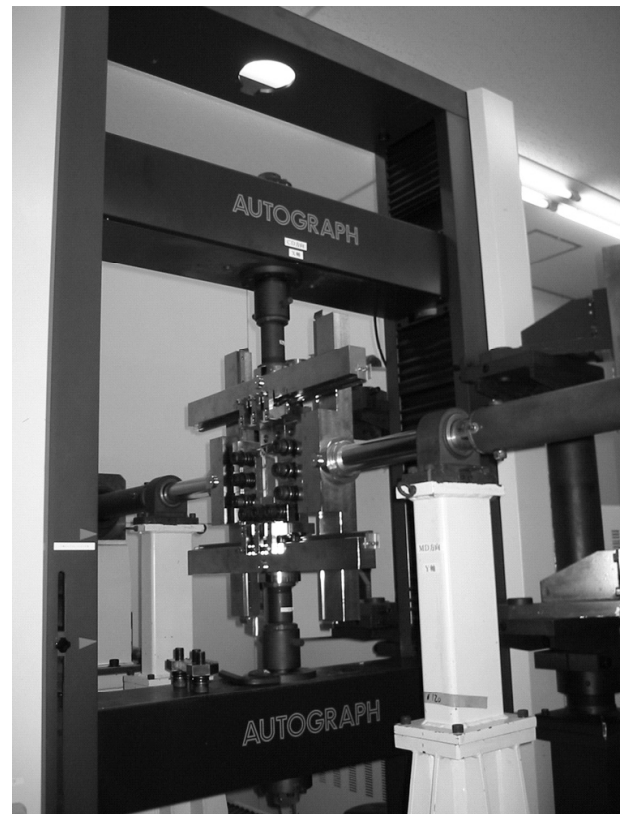
写真-1 二軸引張試験装置（所有：大阪府立産業技術総合研究所）
