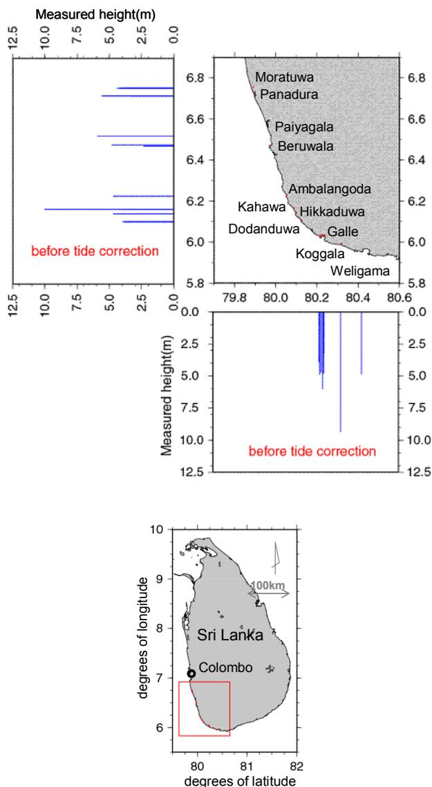
図-2.6 スリランカ南西部の海岸付近の津波痕跡高さ<sup>7)</sup>
