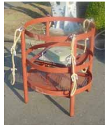
写真 19 散気装置（水中沈設）
