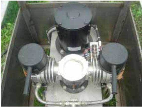
写真5 ピストン式空気圧縮機（水平対抗型）
