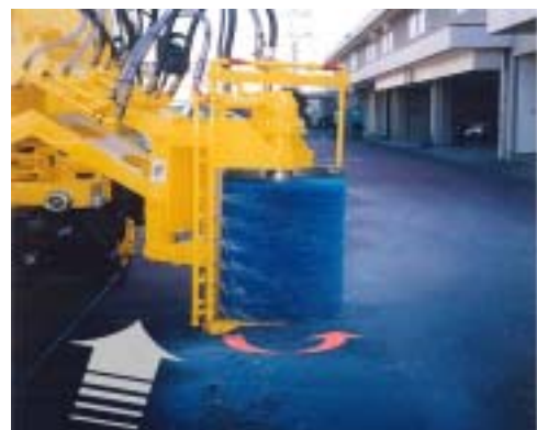
写真 7 - 1 実験に使用したガードレール清掃車と作業装置
