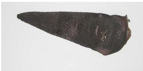
面の凹凸:「曲面」 ・ 破断面の状態:「荒い」
