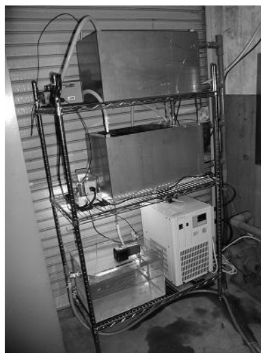
写真1 現地魚類曝露試験装置
