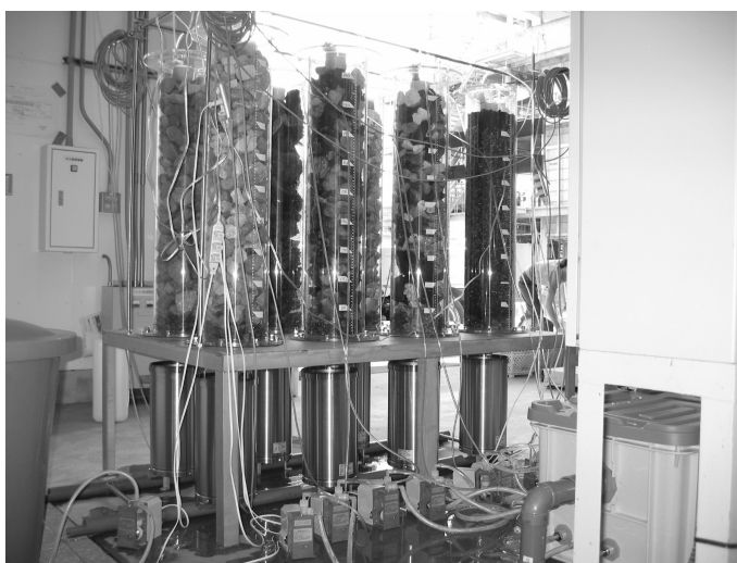
写真－１ カラム通水実験装置の組立状況
