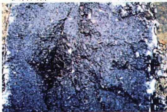
試料内部 アスファルト剥離が進行している
