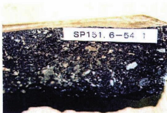
試料内部 アスファルト剥離が進行している
