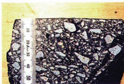
ピンホール部分断面 層内へ連続した空隙が存在
