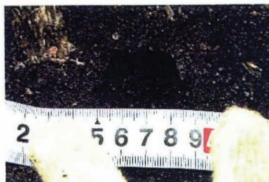
直径 3 cm程度の穴が存在している
