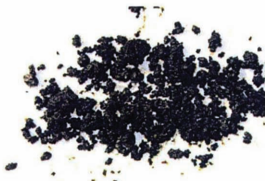
湿潤部分の混合物はアスファルトの剥離が進行している。
