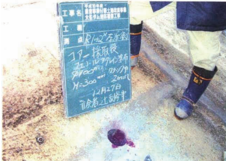
コアー抜き調査。R1+2mコア採取孔内フェノールフタレイン塗布後。
