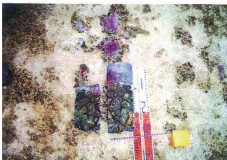
同上コア。接写。コア芯部の亀裂面は発色程度弱い。
