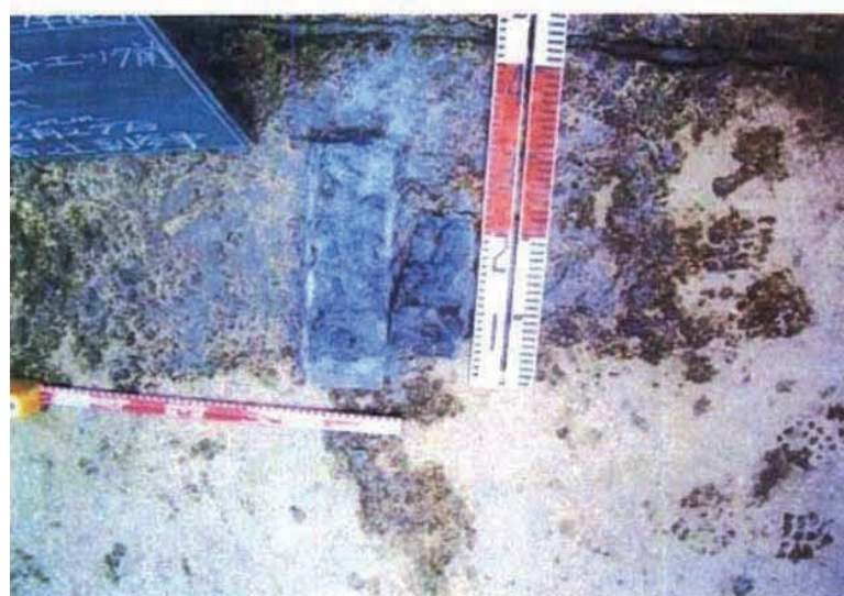
コア一抜き調査。同上フェノールフタレイン塗布前の半割れ面。
