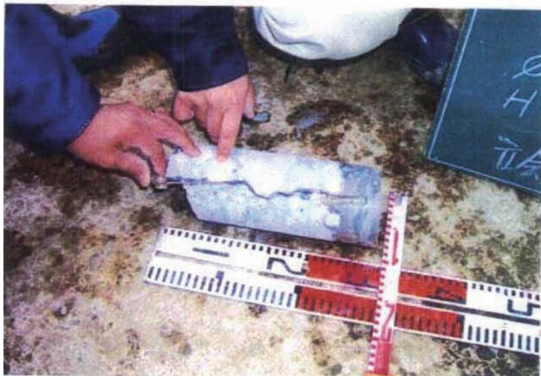
コアー抜き調査。同上フェノールフタレイン塗布前。
