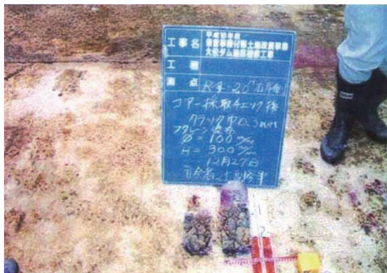
コアー抜き調査(R4-2.0m)。フェノールフタレイン削孔面塗布後の半割れ面。
