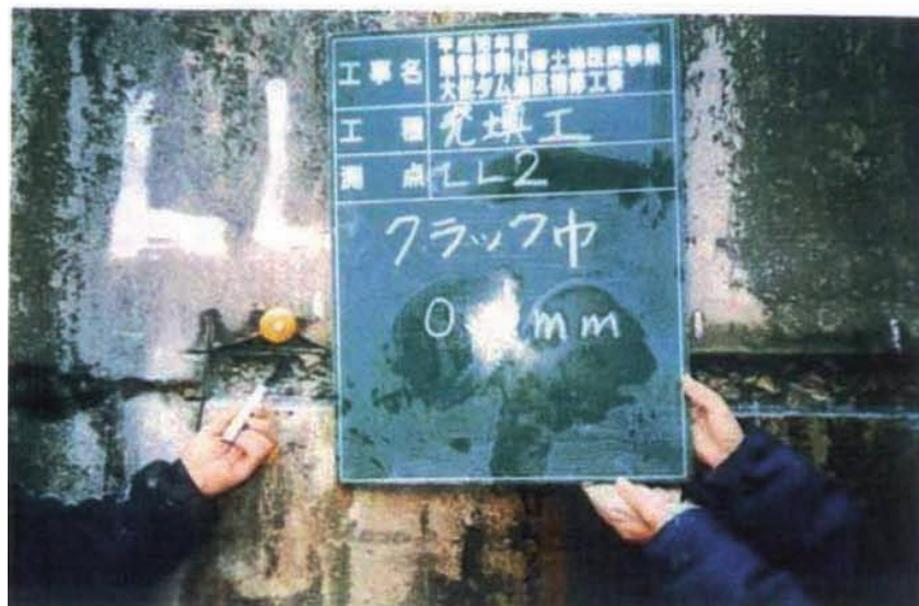
ハツリ後クラック調査(LL2+0m)。開口幅0.1mm。
