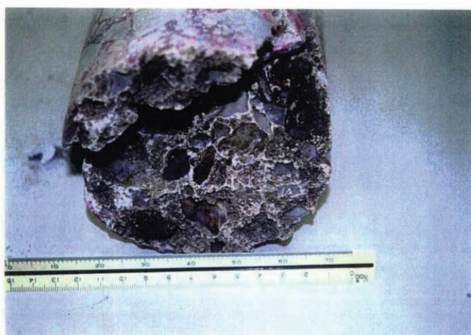
亀裂部表面 石灰岩凹状変化 基質端部は鋭角
