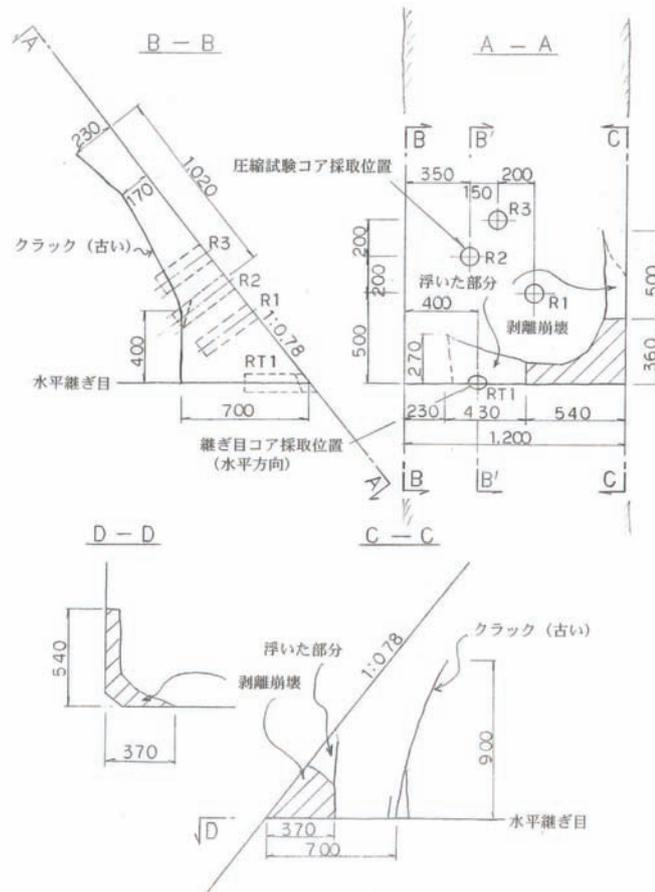
図 2.1 右岸導流壁剥離部スケッチ
