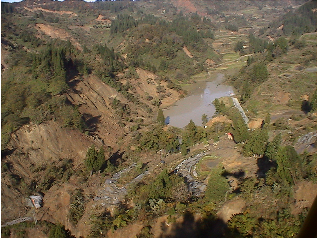
写真 G 5.4 寺野地区で発生した河道閉塞（平成 16 年 11 月 28 日撮影）
