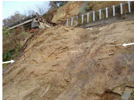
写真 9.2.52 道路下の露頭に見られる凝灰質の薄い挟み層(幅約 5cm)
