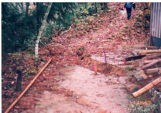
写真 5.38 滝谷北地区西斜面亀裂発生状況
