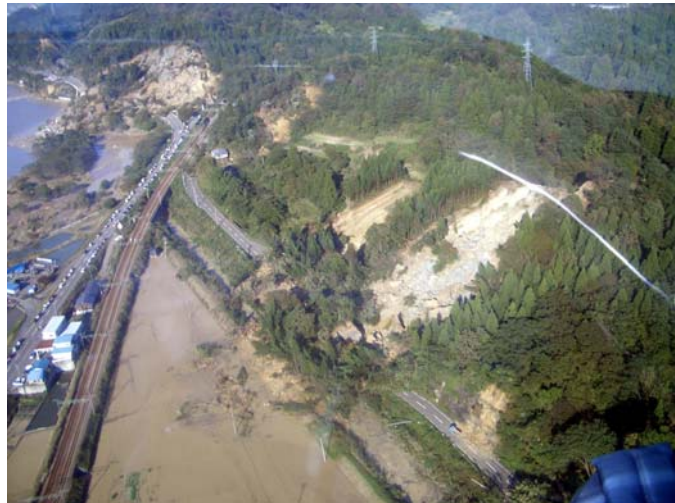
写真 5.45 地すべり地の上流側斜面に見られる層理面を境界とする2つの崩落
