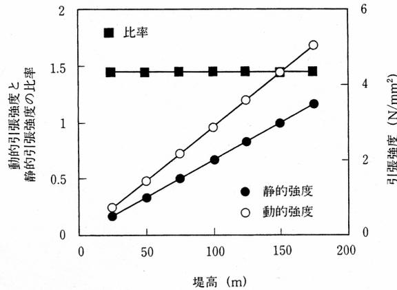
図-1.9.4 静的引張強度と動的引張強度の関係
