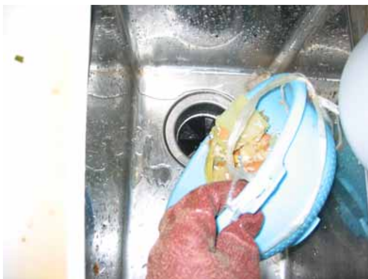
写真 3.2.2 厨芥の水質転換率調査の状況（厨芥の投入状況） 8)
