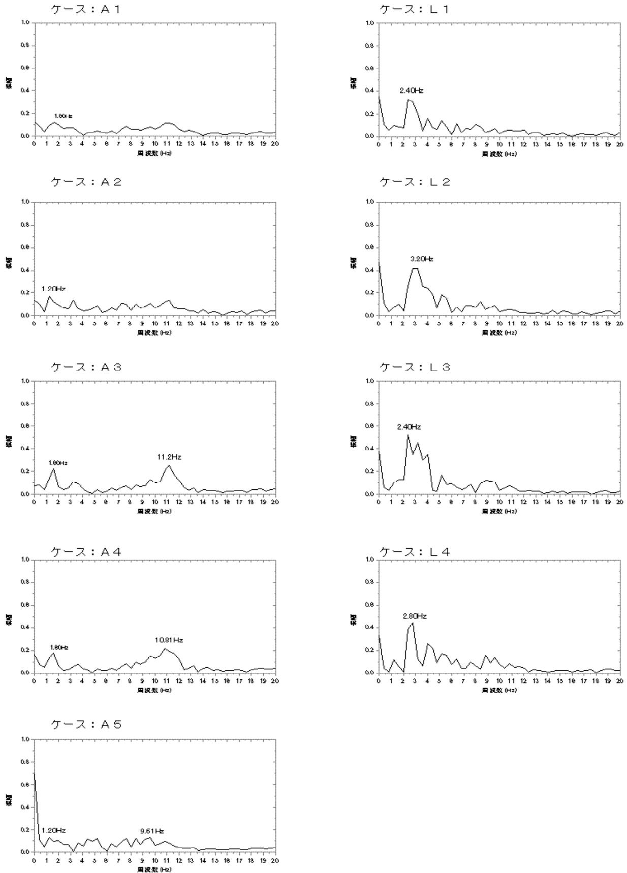
図-2.4.20(a) 単独段差試験軸重変動の周波数特性
