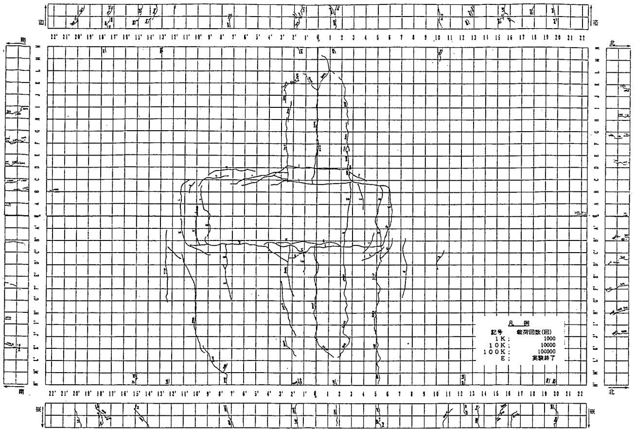
付図-7.12.1 RC47-3 供試体のひび割れ状況 (床版上面)
