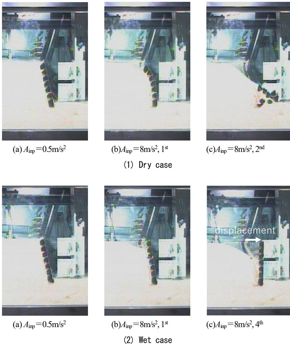
図 3.1.5 加振後の擁壁の変形状態
