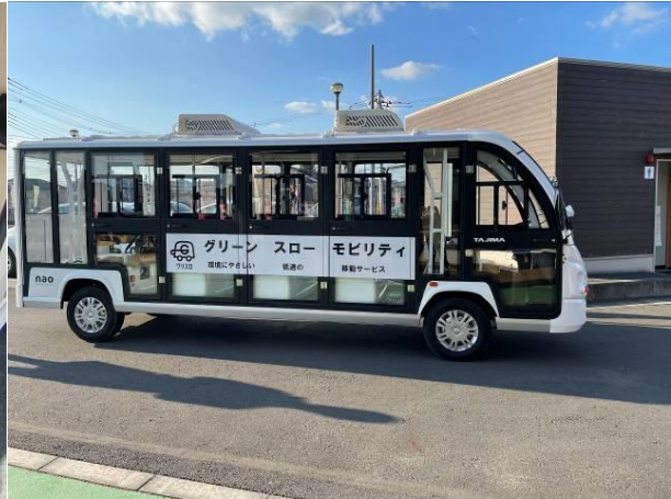
図 2.4.33 ドアが設置されているグリーンスローモビリティ（TAJIMA NAO）
