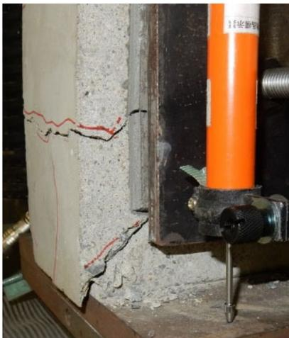
試験区間のコンクリート ( $\sigma_B=24.1\text{N/mm}^2$ )
