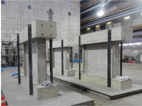
(a) 製作した同一形状、同一配筋の試験体
