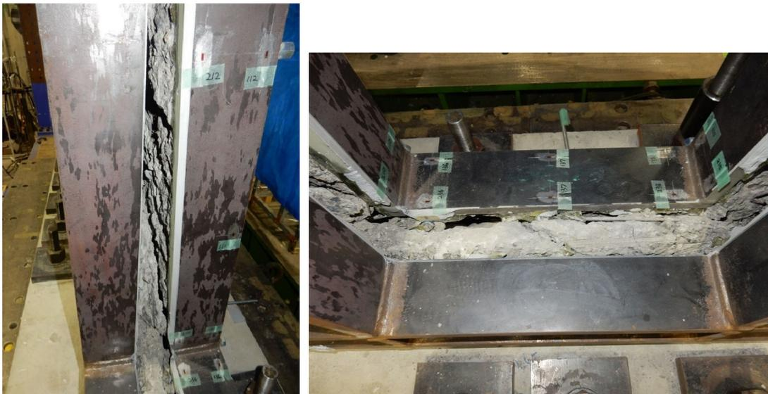
(鉄骨枠間の隙間から確認できる壁板の損傷状況)
