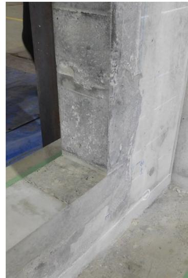
(c) 欠損部の補修 (WOE 試験体)
