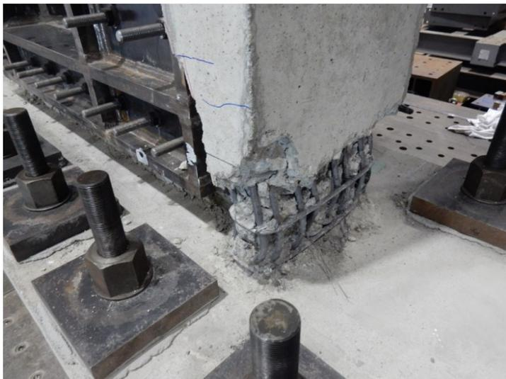
(南側の直交壁、直交壁一壁板間の損傷)
