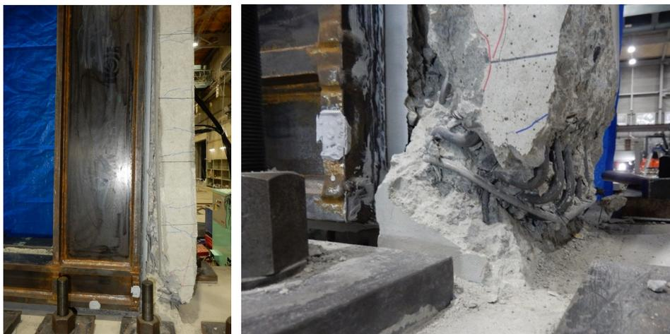
(南側の直交壁、直交壁—壁板間の損傷)
