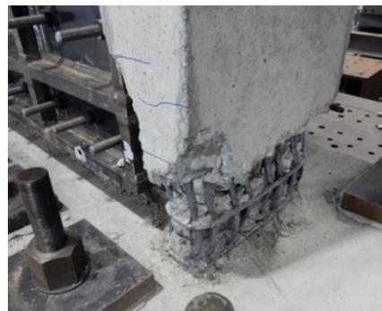
写真2.3.4 各試験体の実験終了時の損傷状況
