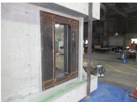
(g) 開口補強試験体 WOE の完成状況
