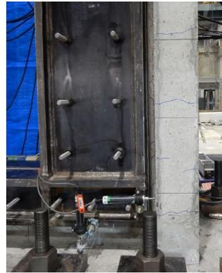
(南側の直交壁-壁板間の損傷)
