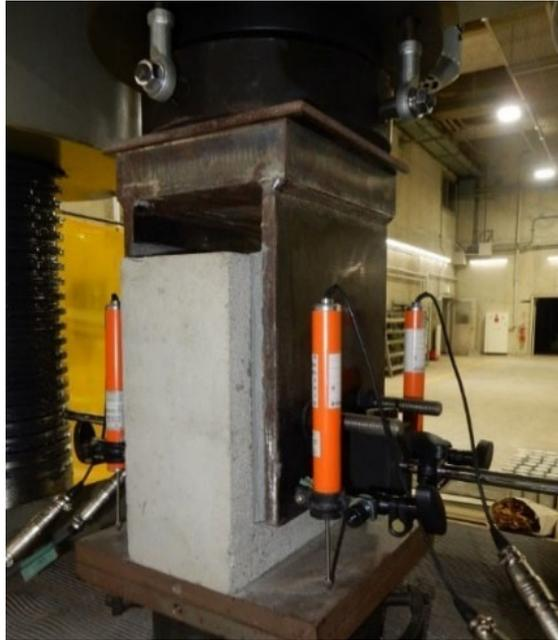
写真2.3.2 要素試験における加力と計測
