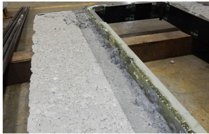
(d) 鉄骨枠に張り付いた壁板のコンクリート
