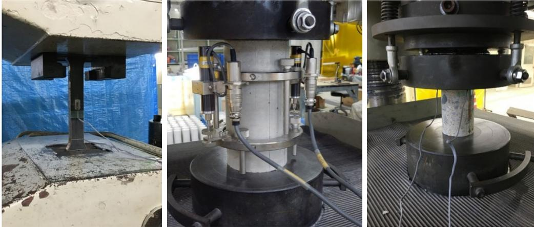
(a) 鋼材の引張試験 (b) コンクリートの圧縮試験 (c) コア試験体の圧縮試験
