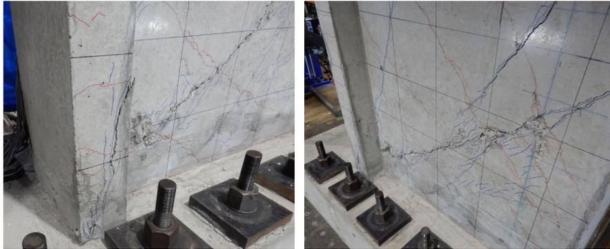
(北側の直交壁、壁板の損傷)
