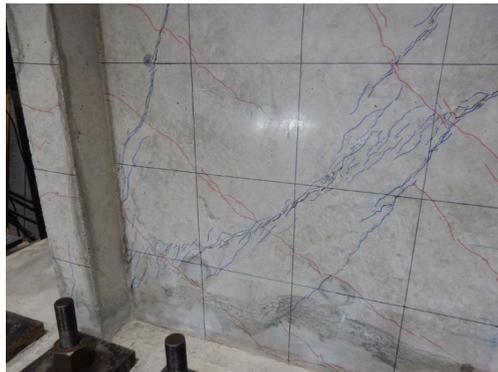
(北側の直交壁、壁板の損傷)
