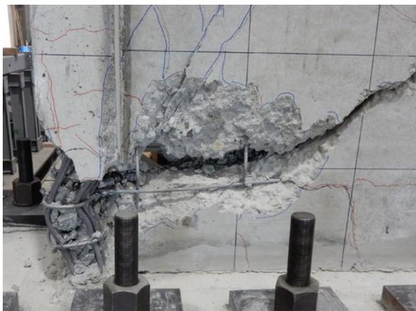
(南側の直交壁、壁板間の損傷)
