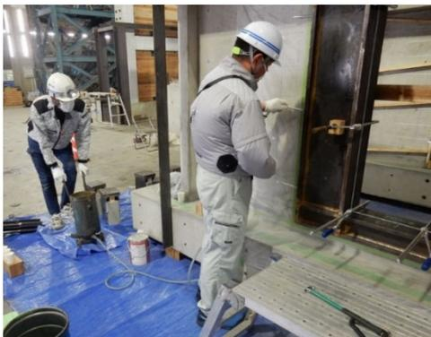
(e) 開口補強試験体 WOE のエポキシ樹脂充填
