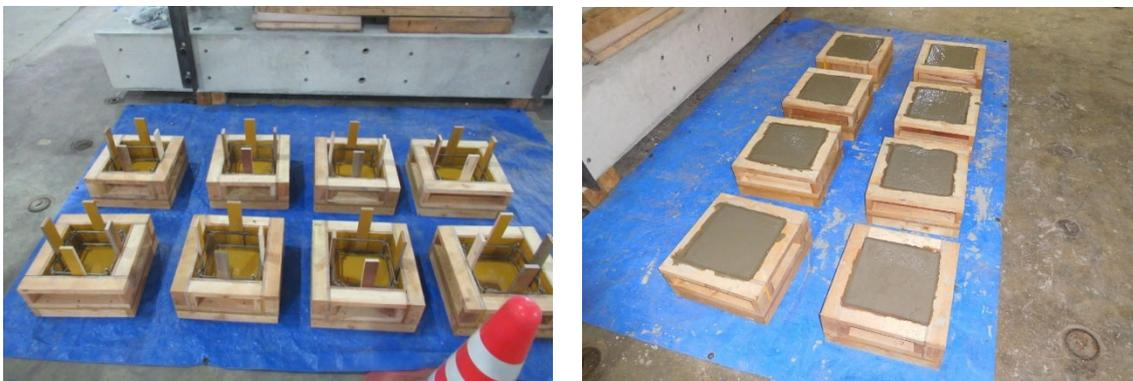
写真 2.2.2 要素試験体（E2、B2）の製作
