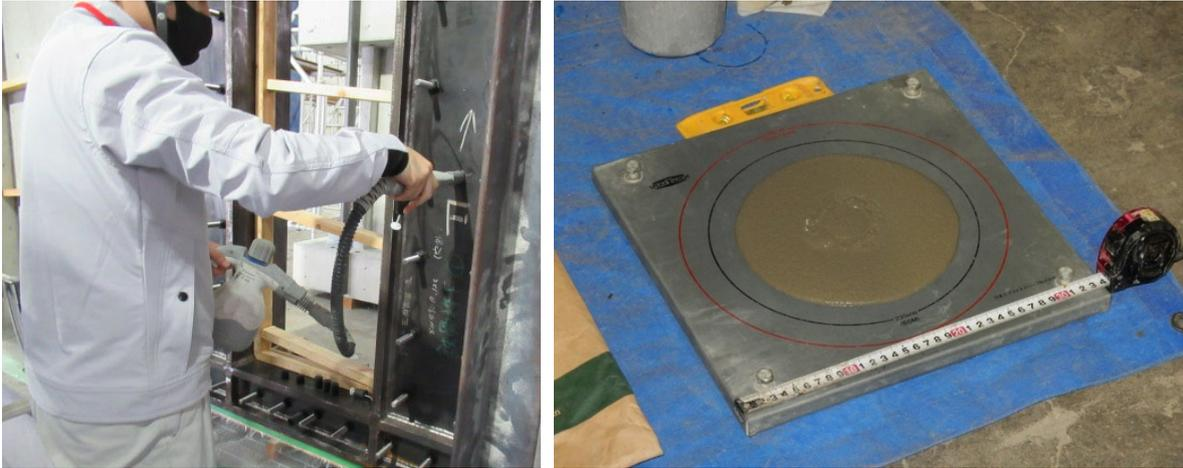
(b) 型枠内へのスチームの注入、フローの確認
