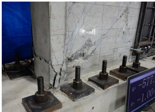
(北側の直交壁、壁板の損傷)
