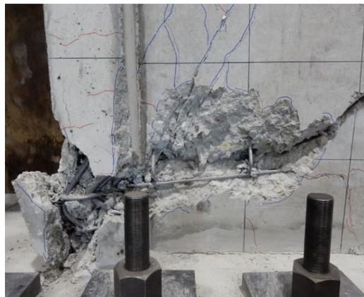
(北側の直交壁、壁板の損傷)
