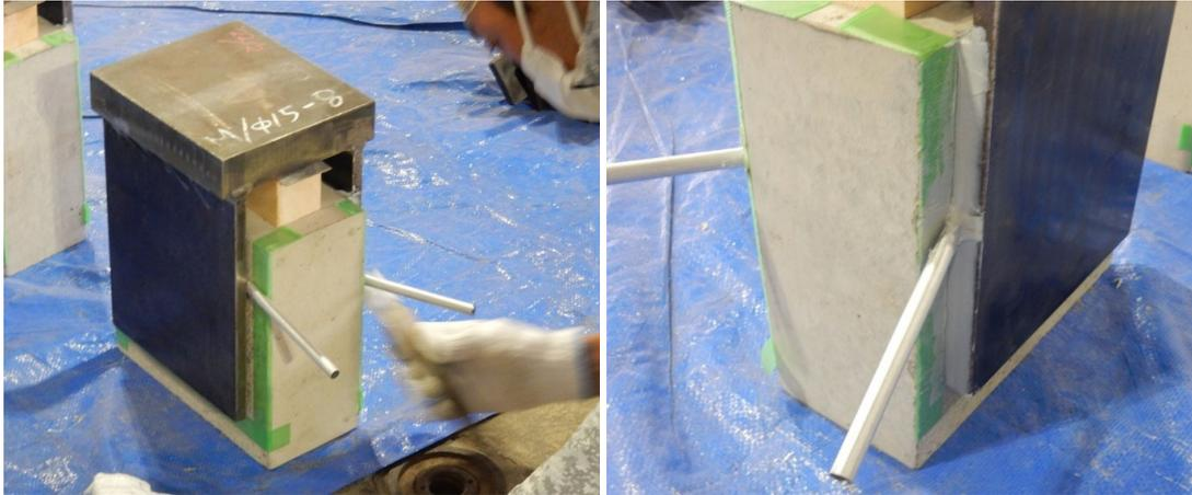
(a) シール材の塗布、アルミパイプの取り付け
