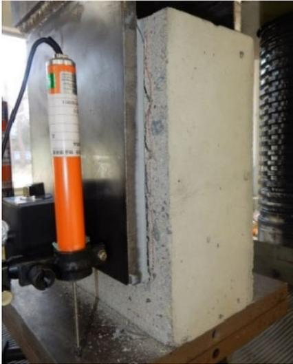
試験区間のコンクリート ( $\sigma_B=24.1\text{N/mm}^2$ )
