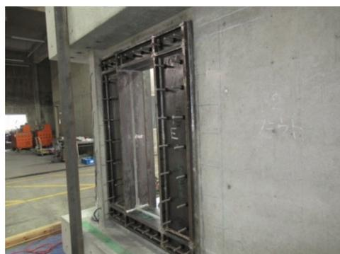
(h) 開口補強試験体 WOB の完成状況
