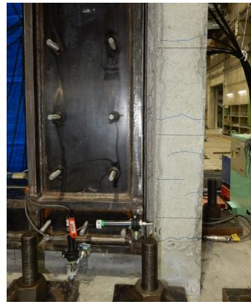
(南側の直交壁-壁板間の損傷)
