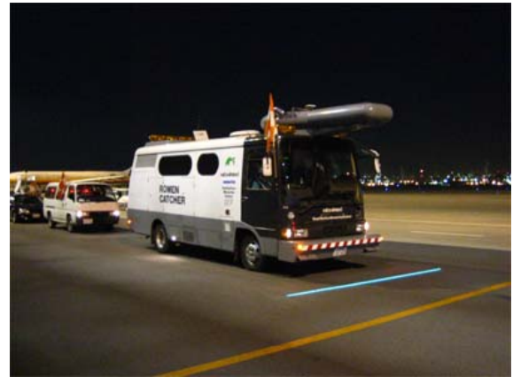
写真-4.1 路面性状測定車
