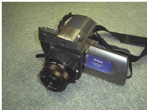
写真-3.2 赤外線サーモグラフィ
