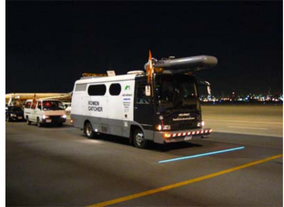
写真-4.1 路面性状測定車
