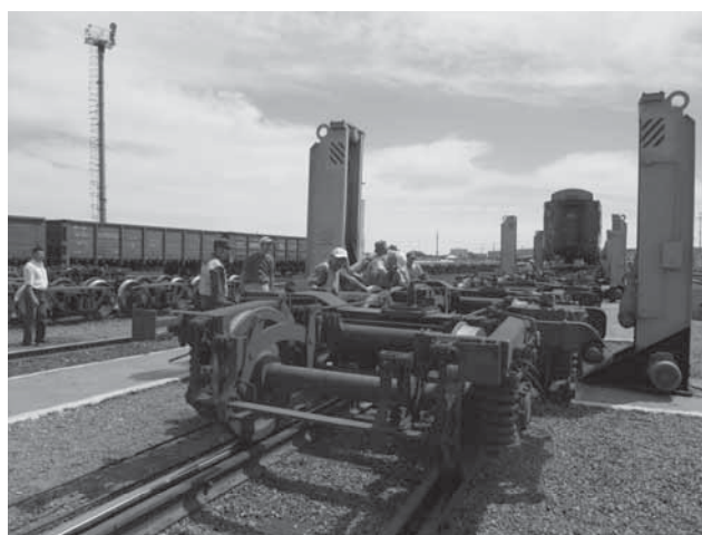
写真 A14-5 台車交換の様子
