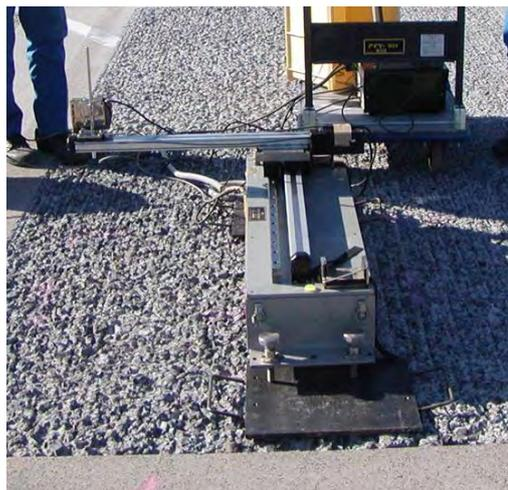
写真-4.3.1 レーザ変位計によるプロファイル測定状況
