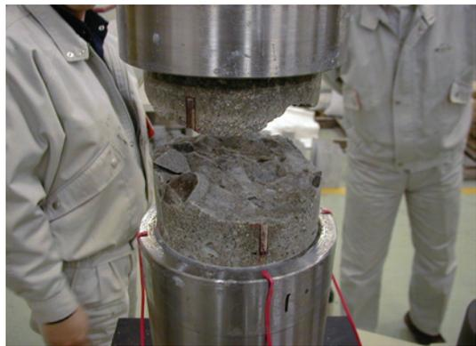
写真-3.1.10 破断面の状況
