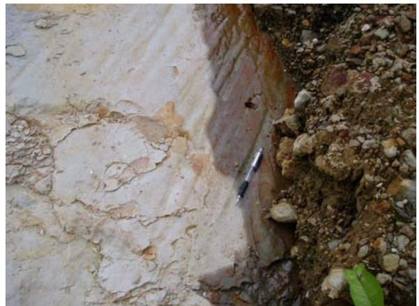
写真-4.11 すべり面に見える擦痕
