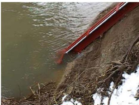
写真-4.20 濁度計の設置状況（平成17年2月23日撮影）
