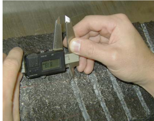
写真-3 溝幅の測定
