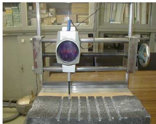
写真-4 溝深さの測定
