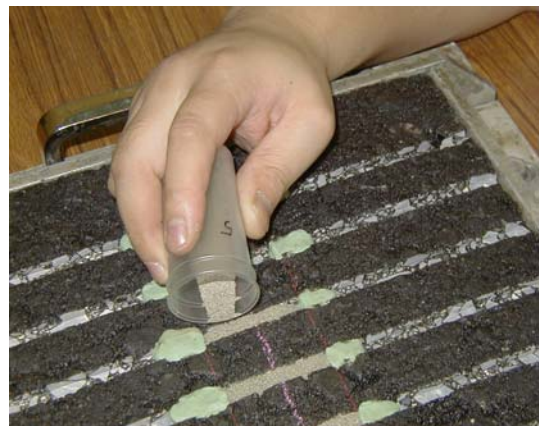
写真-2 グルーピングの溝の容積測定状況
