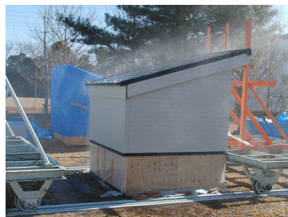
写真 外壁および屋根への強風撒水試験状況
