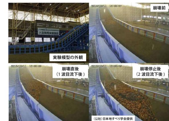
写真 実験模型と崩壊の様子
