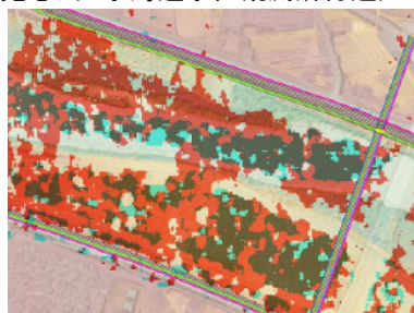
図3 SAR強度差分情報による水際線の推定 (最上川 長崎水位観測所付近)
