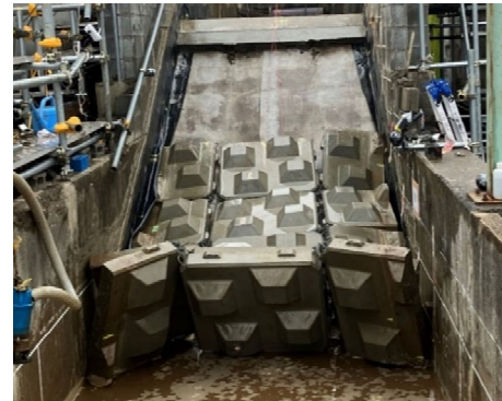
写真 2 流出したブロックの状況
