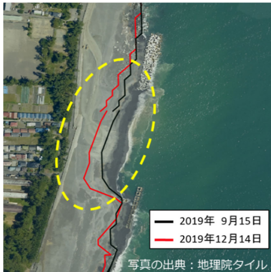
図-1 10月に通過した台風による大規模な海岸侵食前後に撮影された衛星画像からの海岸線抽出結果。黄色で囲った箇所では、台風後に侵食が確認されている。
