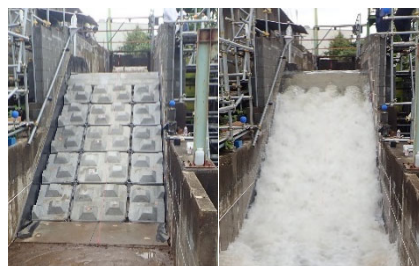
写真1 （左）堤防模型の外観（右）通水時の状況
