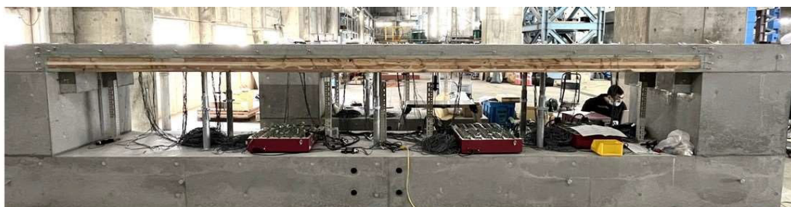
写真 2 RC と CLT の合成床版の実大施工実験試験体
