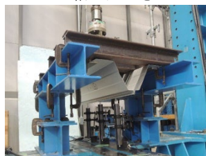
折板ぶきの接合部
