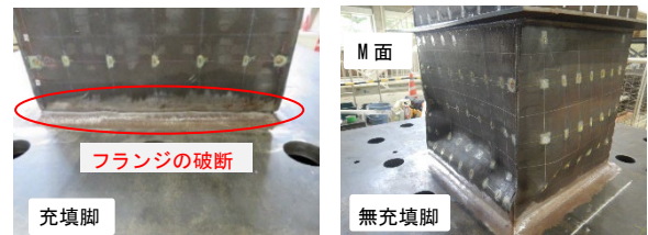
写真-2 試験後試験体状況 (M面)
