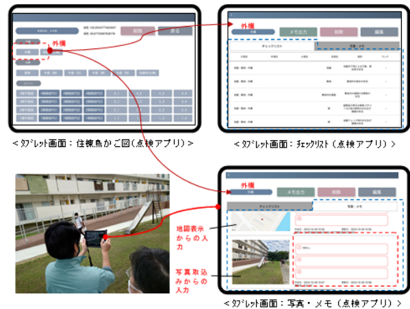
図 3. 屋外施設（遊具）の点検の様子
