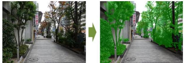
図-1 AI 緑視率調査プログラムによる緑視率計測例
