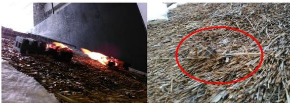
写真-1 飛び火試験時の状況とクリブ設置位置の状況
