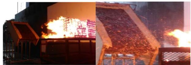
写真-2 火の粉による実験状況と飛散状況
