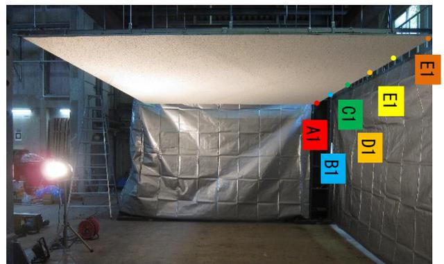
図-7 吊り天井試験体
