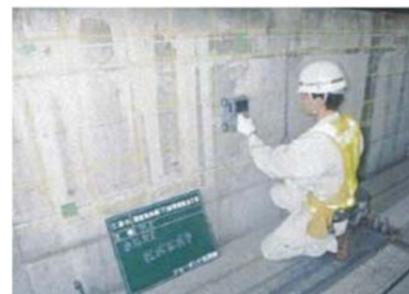
写真⑦-1 鉄筋探査状況
