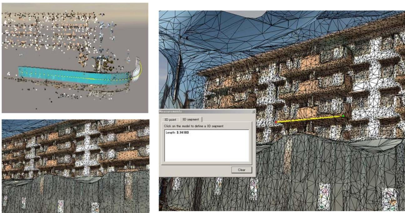
図 4.3.3-10 全周囲カメラによる簡易計測の例（集合住宅）
