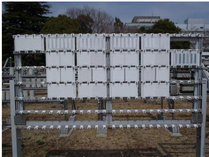
写真Ⅲ.3.16 材料相性評価用屋外暴露試験体 (2018年3月撮影)
