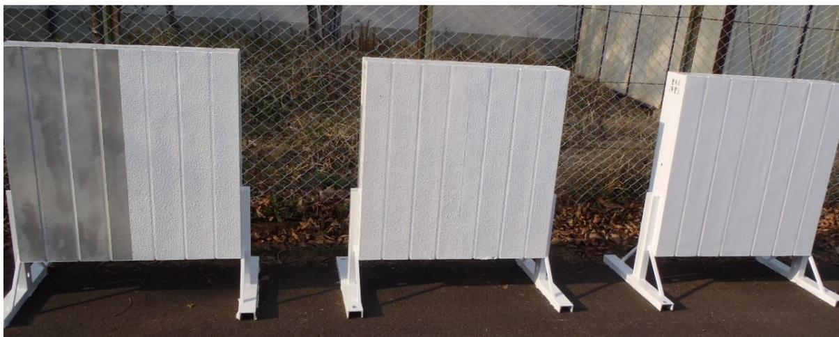
写真Ⅲ.3.17 目地接着性評価用屋外暴露壁試験体 (2018年4月撮影)
