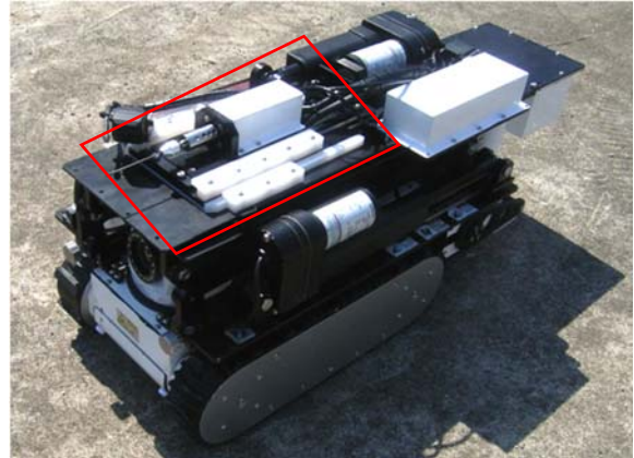
写真 5.9.8 床下劣化診断装置へのドリルユニット(赤枠内)搭載状況
