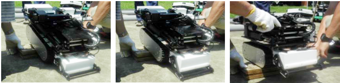
写真 5.8.2 フリッパーを利用した障害物の乗り越えの状況
