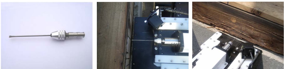
写真 5.8.3 診断部に追加した穿孔機能
