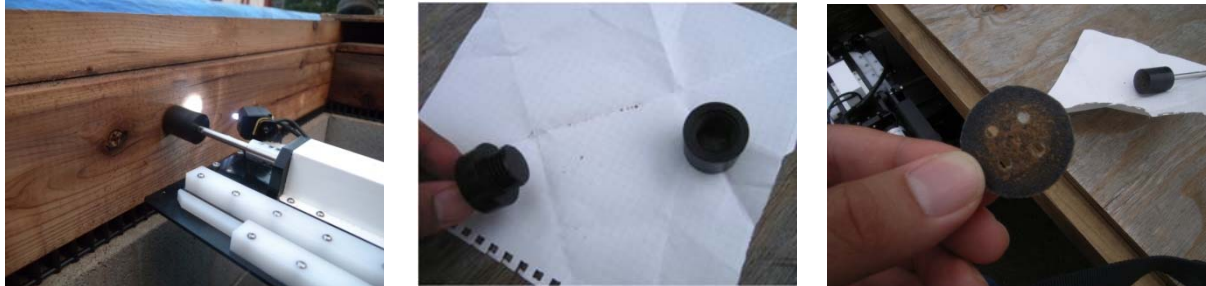
写真 5.8.4 診断部に追加したサンプル採取機能
