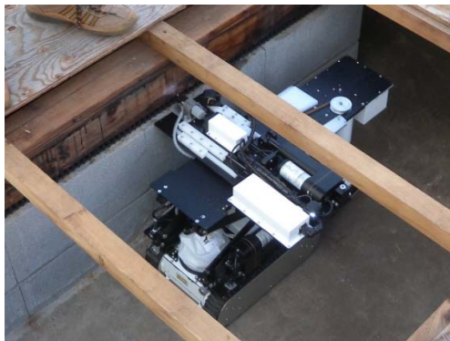
写真 5.9.1(診断状況 1: 診断装置の設置状況)
