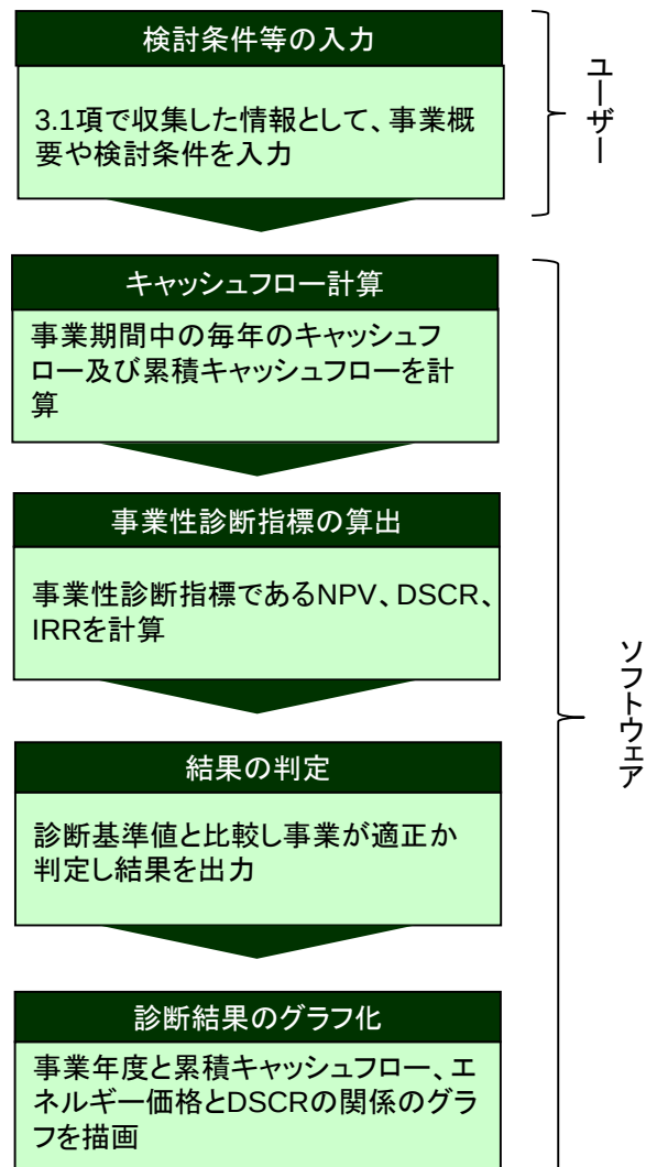
図 5 ソフトウェアによる診断の流れ
