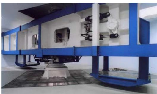
図 3.5 実験装置（遠心力裁可試験装置）
