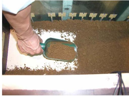
図 3.9 地盤材料の撒き出し状況
