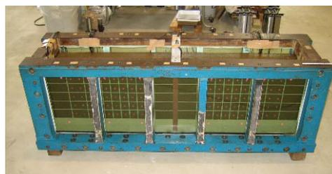
図 3.6 試験体土槽
