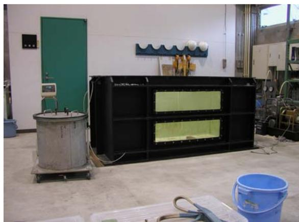
図 3. 14 地盤の飽和に用いた脱気槽と注水タンク
