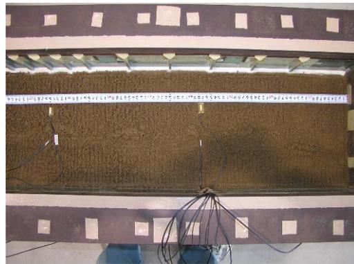
図 3.11 加速度計と水圧計の設置
