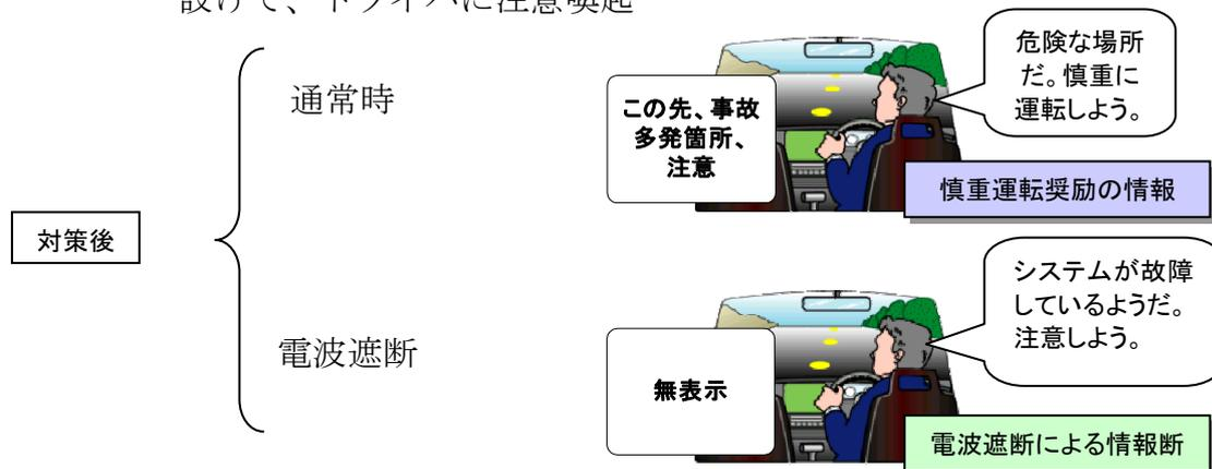
図 4.1.3-10 電波の遮断に対する対策案（対策後）
